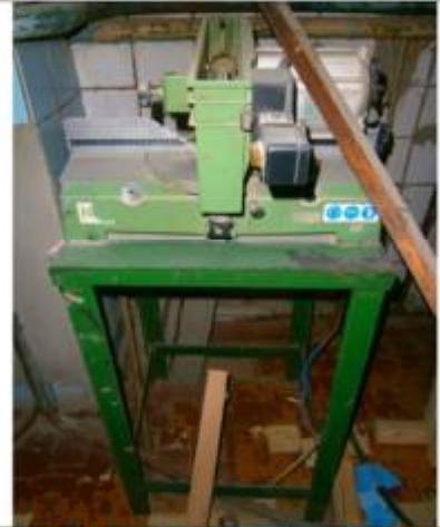
Фото-таблиця № 2 до звіту з незалежної оцінки майна № Пр 6/1. Верстат для порізки алюмінію (VL1500. Матеріал: сталь/нерж.сталь, мірна лінійка 1,5 м., напряга 380 V)
