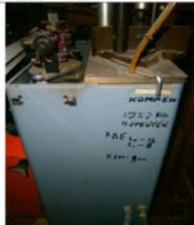
Фото-таблиця № 3 до звіту з незалежної оцінки майна № Пр 6/1. Екструдер (ОНЕ 04, сталь, дозатори — 8 шт., напруга 380 V, потрібна потужність — 6 kW, швидкість подачі герметика — 0,1 кг/хв., об'єм бака — 40 л.
