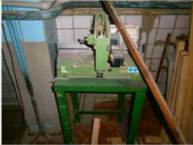
Фото-таблиця № 2 до звіту з незалежної оцінки майна № Пр 6/1. Верстат для порізки алюмінію (VL1500. Матеріал: сталь/нерж.сталь, мірна лінійка 1,5 м., напряга 380 V)
