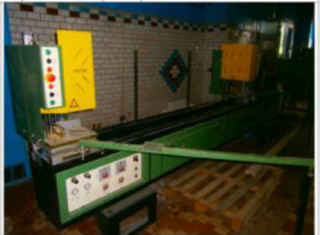
Фото-таблиця № 1 до звіту з незалежної оцінки майна № Пр 6/1. Верстат зварювальний ВВ 2020-1, serial№ 1524, 4 kW, 220 V.
